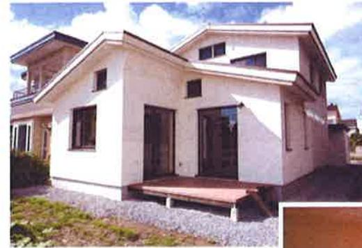
300mmと壁の断熱が厚いので、窓が引込み奥行きのある表情となっている
